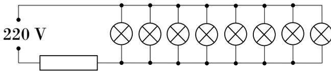
7. Восемь одинаковых лампочек от карманного фонарика (номинальные напряжения 4,0 В и ток 0,25 А) подсоединены в электрическую сеть так, как показано на рисунке. Напряжение в сети 220 В. Сопротивление обеспечивает номинальное напряжение на лампочках. Возрастет или уменьшится суммарная мощность лампочек, если одна из них перегорит? Обоснуйте ответ. Зависимость сопротивления лампочек от температуры нити накала не учитывать. (10 б.)
