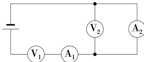
8. В изображённой на рисунке электрической схеме два амперметра и два одинаковых вольтметра. Амперметр  $A_1$  показывает силу тока  $I_1 = 200 \text{ мкА}$ , вольтметры показывают напряжения, соответственно,  $U_1 = 100 \text{ В}$  и  $U_2 = 2 \text{ В}$ . Каково показание амперметра  $A_2$ ? (10 б.)
