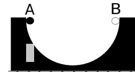
**9. (U-ТРУБКА )** В U-образную трубку с равномерной площадью по-перечного сечения  $S$  налита вода плотностью  $\rho_v$ , так что более половины U-трубки заполнено водой, а длина каждой незаполненной части равна  $h$ . Один конец U-трубки герметично закрывают, а в другой конец медленно заливают масло до верхнего края трубы. Какова была плотность масла  $\rho_o$ , если известно, что высота столба масла была  $l$ ? Атмосферное давление равно  $p_0$ . (12 б.)
