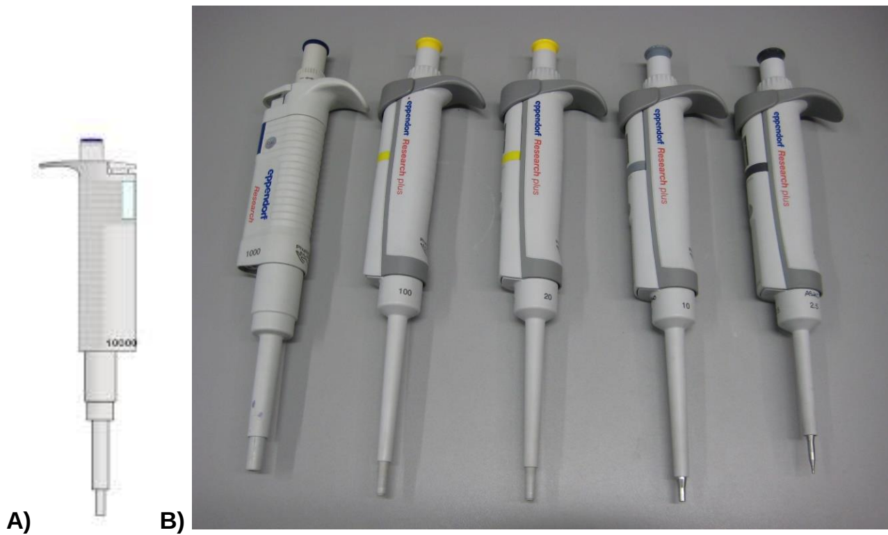
Joonis 16. Automaatpipetid. Joonisel A) on toodud automaatpipeti üldskeem ja joonisel B) erineva mõõtevahemikuga automaatpipetid.
