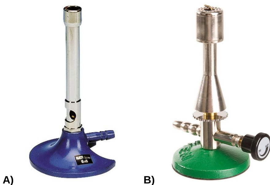
Joonis 25. Gaasipõletid. Joonisel A) on toodud Bunseni põleti ja joonisel B) Teclu põleti.
