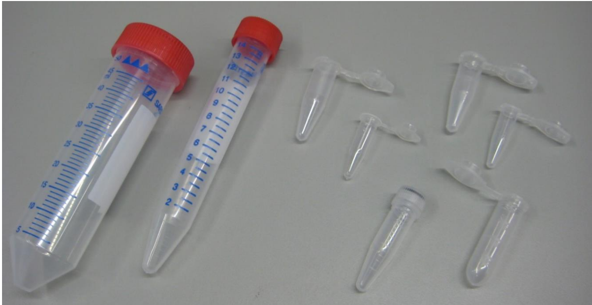
Joonis 34. Erinevad plastikust tsentrifuugituubid.
