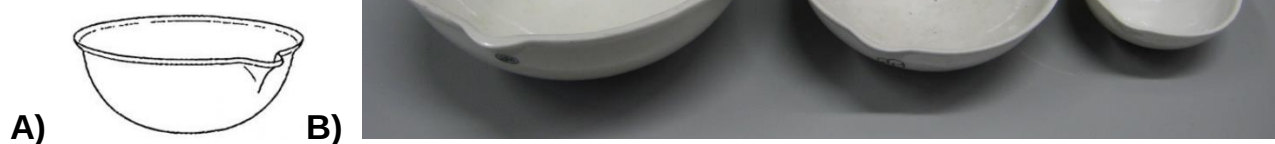
Joonis 20. Portselankausid. Joonisel A) on toodud portselankausi üldskeem ja joonisel B) erineva suurusega portselankausid.
