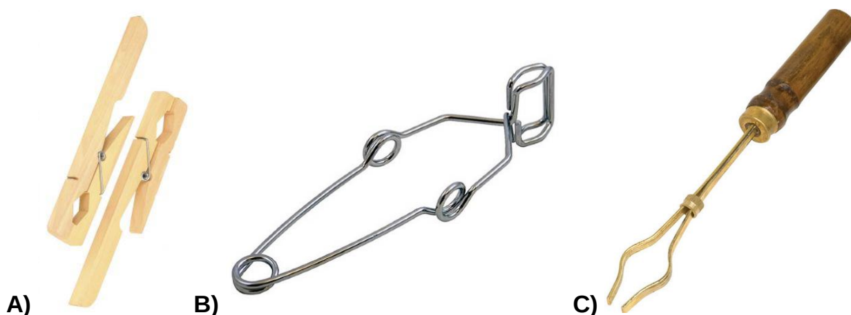
Joonis 2. Erinevast materjalist ja kujuga katseklaasihoidjad. Joonisel A) on toodud puidust, joonisel B) metallist ja joonisel C) metallist katseklaasi hoidja puidust käepidemega.
