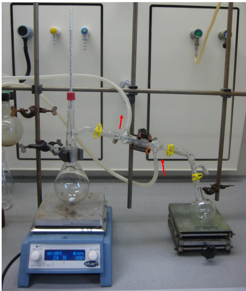
Joonis 38. Lihtdestillatsiooniseadme skeem. Punase nooled pildil näitavad jahutusvee voolu suunda.
